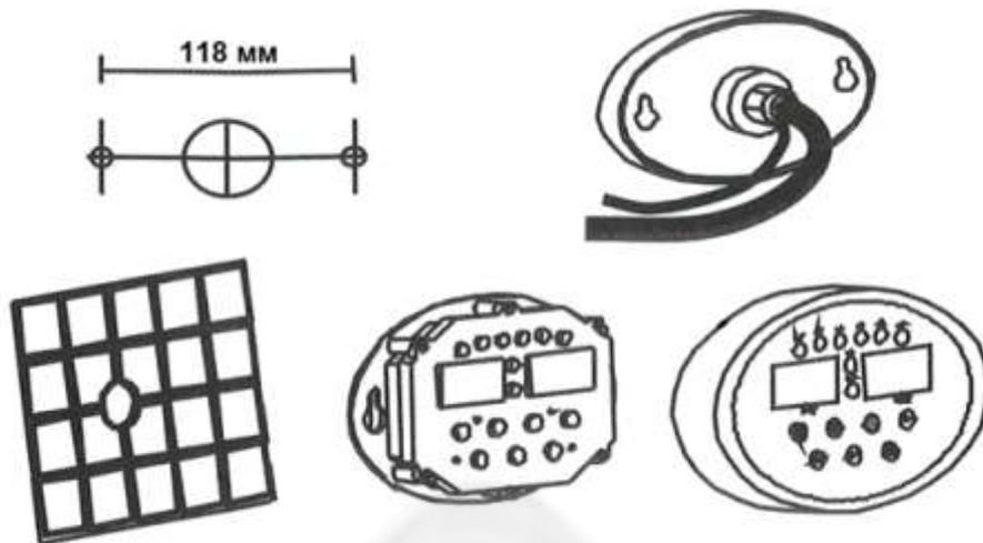
4) Установка датчика температуры: датчик температуры устанавливается внутри парной примерно на расстоянии 1,2 - 1,5 м от пола и двери. Используйте винты диаметром 4 мм чтобы закрепить его на месте, затем соедините с проводом. Для того чтобы влага не попадала во внутрь датчика температуры со стороны стены, используйте прозрачный герметик. При необходимости лишние остатки герметика можно удалить.
