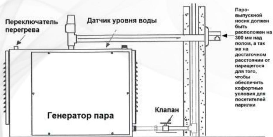
г) Подсоедините сливное отверстие к соответствующей системе слива с помощью медной трубки с соответствующим фитингом (на выходе 3/4 нар.р.) .д) Установите безопасное соединение между пароводящей трубой и наконечником выхода пара.
